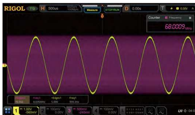
Обычное измерение с использованием 1 млн. отсчетов не позволяет точно измерить частоту высокочастотного сигнала.
