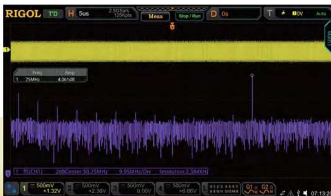
С зондом ближнего поля позволяет легко наблюдать пики на спектрограмме, когда зонд приближается к точке утечки излучения.
